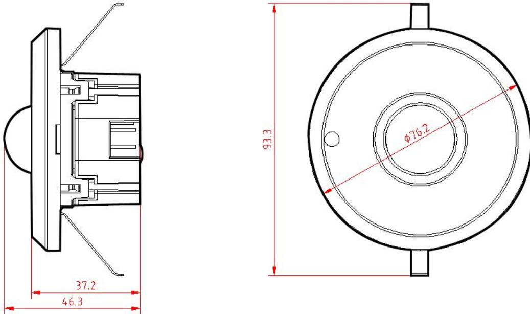
**安装提示：** 本产品便于安装，采用嵌入式安装方式，通过使用产品左右两侧的弹簧片进行固定。该传感器安装孔尺寸大小  $\phi 58\text{mm}\pm 3\text{mm}$ ，安装过程中必须保证产品的操作、安装、测试以及维修正确。
